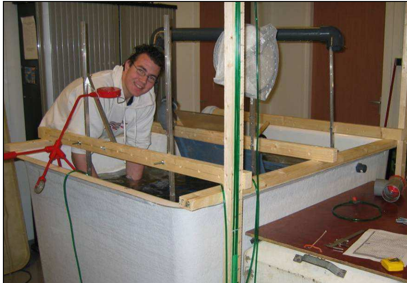
figuur 2.1 Het visbekken (1,75 m 3 ) waarin de hydraulische metingen met de collector zijn uitgevoerd.
