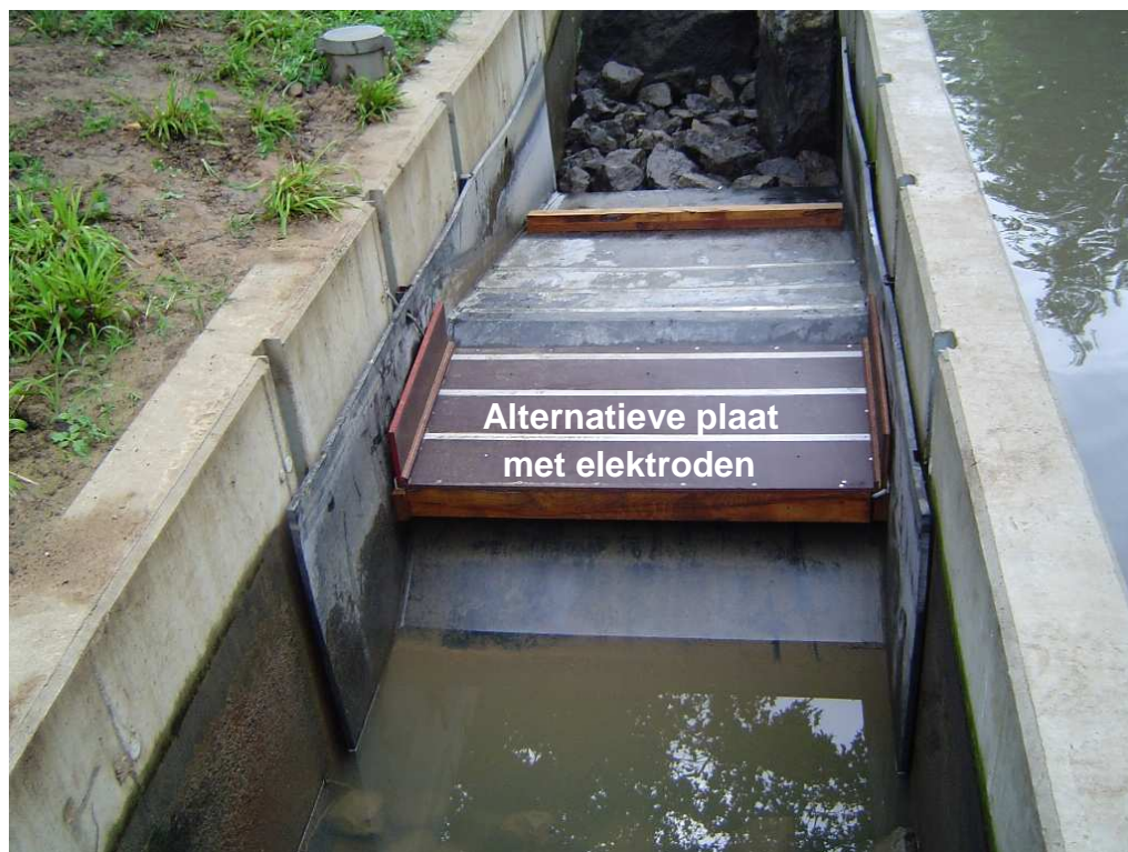
figuur 2.3 Alternatieve set elektroden die vistellingen mogelijk maakt ondanks het turbulente water in de vispassage
